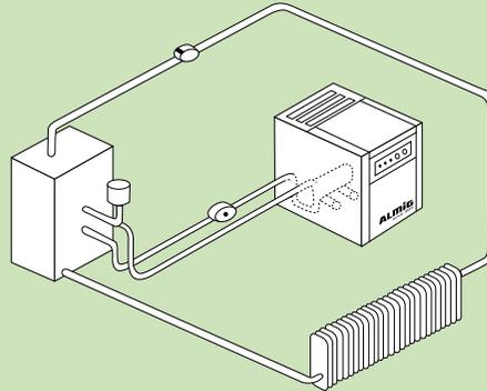
Bei der Heizwasserbereitung kommen Plattenwärmetauscher zum Einsatz.
