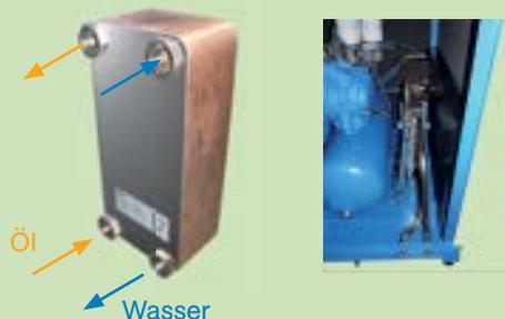
Alle erforderlichen Komponenten für die Wärmenutzung werden bereits bei der Produktion des Kompressors mit eingebaut.
