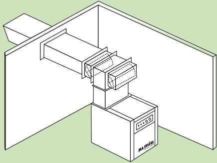
Die erwärmte Kühlluft wird über ein Kanalsystem zur Raumbeheizung verwendet. Durch temperaturgesteuerte Klappen wird eine geregelte, einstellbare Raumtemperatur erzielt.
